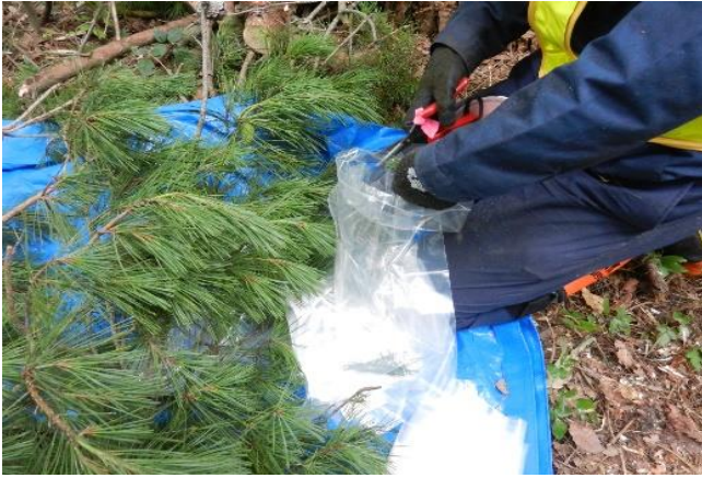
アカマツ新葉・旧葉の放射性物質濃度測定 試験材料採取
