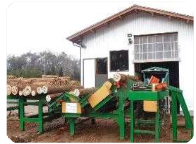
放射線検知装置付きの選木機 (セシウム濃度の確認)
