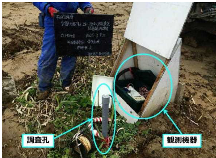
地すべり箇所上にいくつも設けたポイントから地中に観測機器端末を入れて、継続的にデータを取得する
