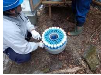
自動ウォーターサンブラ (渓流水の濁度及び放射性物質濃度を測定)
