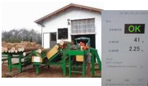
市場での全木検査機による検査
