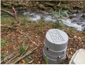
自動ウォーターサンブラ (渓流水の濁度及び放射性物質濃度を測定)
