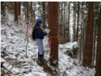
立木状態で表面計数率を測定
