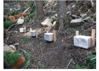
土砂受け箱 (斜面の土砂等の移動量を計測)
