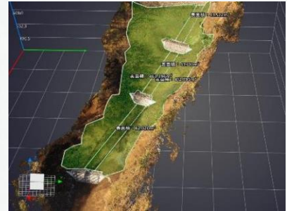
点群データを用いた 出来形管理
