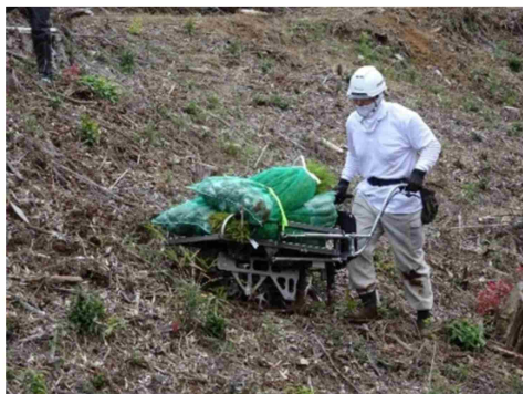
▲ 植穴掘り機能付き 電動運搬車による苗木植栽
