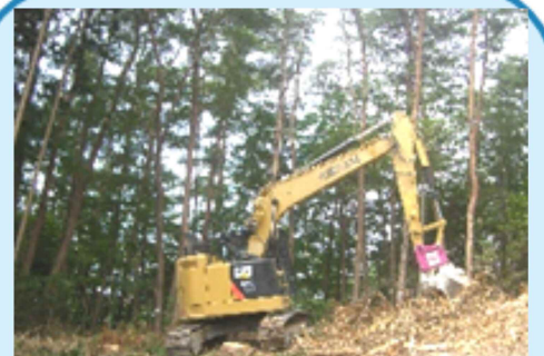
フェラーバンチャ付きグラップルバケットによる地拵え作業
