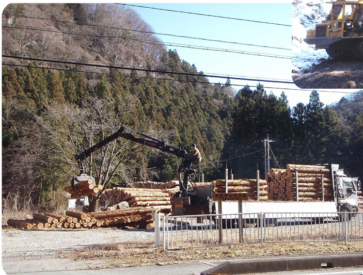
寺社平山元土場でのはい付け作業の様子
