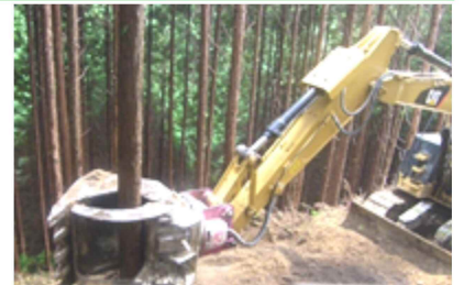
フェラーバンチャ付きグラップルバケットによる森林作業道開設
