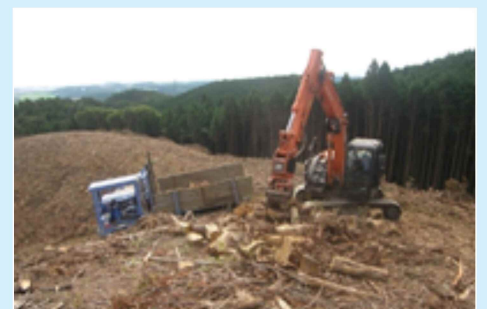
グラップル及びフォワーダによるD材の搬出
