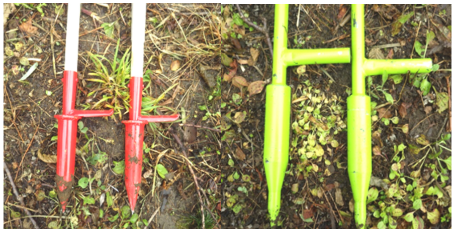
改良型 デイブルの柄を木製にして軽くした 容器苗植栽用の器具 デイブル
