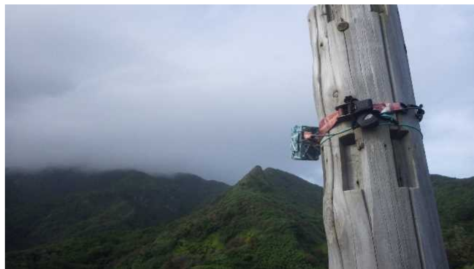
母島小剣先山に設置している気象観測用のカメラ
