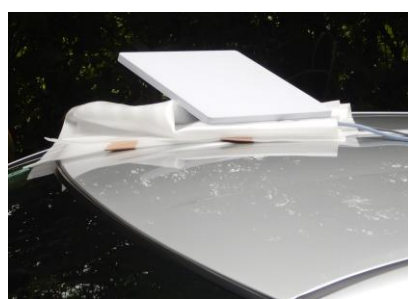
⑦ 車の屋根に設置した衛星アンテナ
