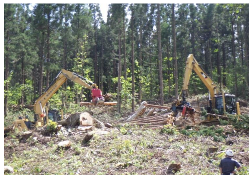
造材集材作業（一貫作業）
