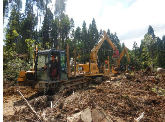
④林業機械による連続作業状況 (プロセッサ造材→グラップル集材→フォワーダ運材)
