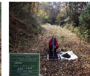
路盤土壌中の放射性物質濃度測定
