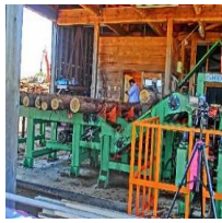
放射線検知装置付きの選木機(セシウム濃度の確認)
