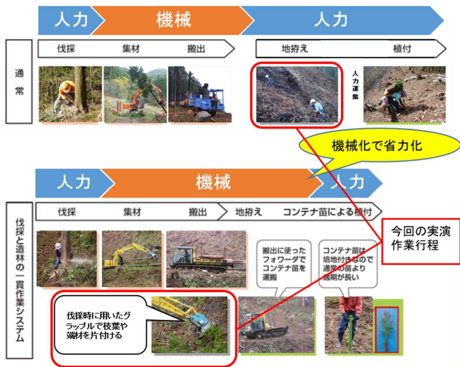
図1 「伐採と造林の一貫作業システム」の仕組み
