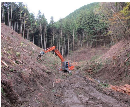
高性能林業機械を活用した地拵作業 （一貫作業システム）（大田原市南方）
