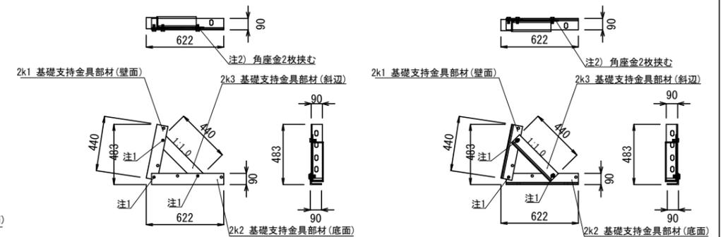
注1: 組立用ボルト(Ka)・ナット(Kb)・角座金(Kc)を1個ずつ使用して組立てる。
