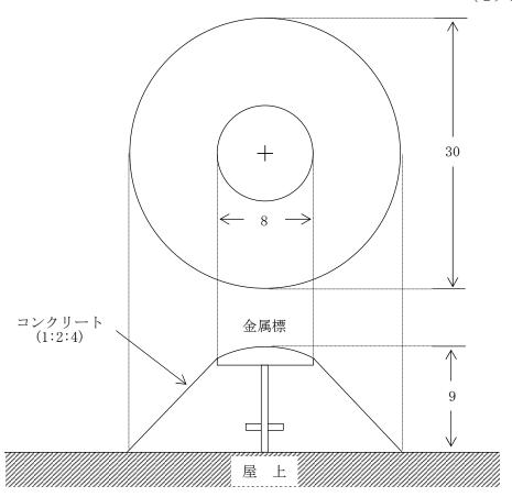
4) 図根点(金属標)屋上埋設図(その2)
