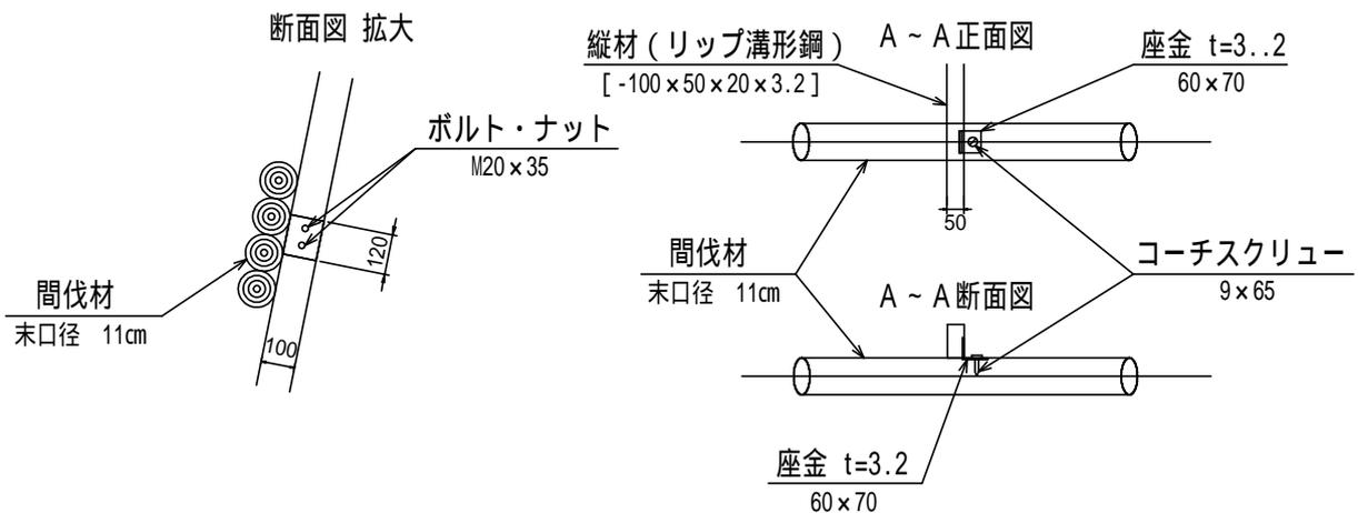
丸太残存型枠工(治山ダム用) 材料表
