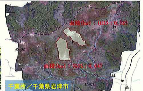
オルソ画像を活用した被災面積の測定
