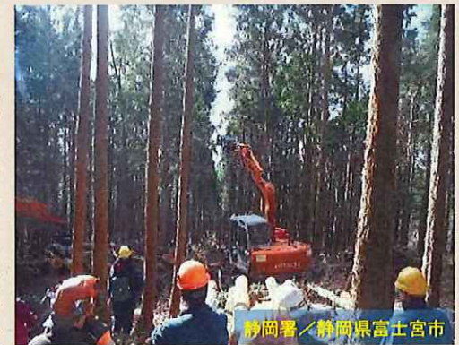
スイングヤーダによる木寄せ集材のデモンストレーション
