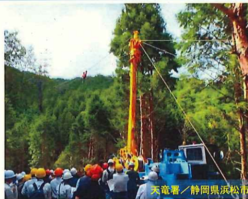
生産性向上の現地検討会 (5胴式タワーヤーダによる架線集材のデモンストレーション)
