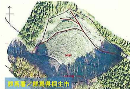
オルソ画像を活用した作業道距離の測定
