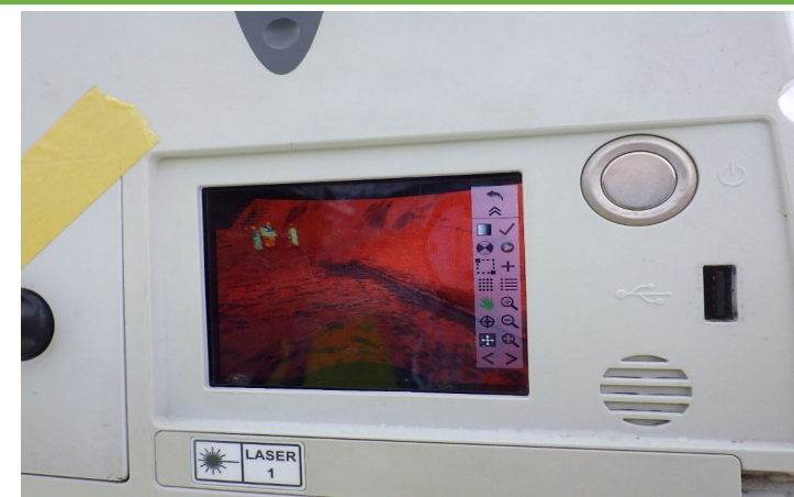
地上型レーザースキャナー出来形管理
