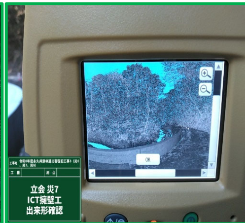
地上型レーザースキャナによる出来形立会・確認
