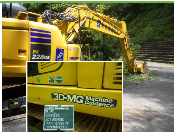
ICT機械(3次元マシンガイド)バックホウ山積0.8m 3 )
