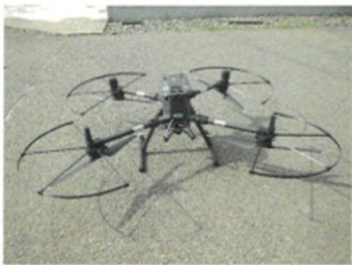
無人航空機搭載型レーザースキャナー
