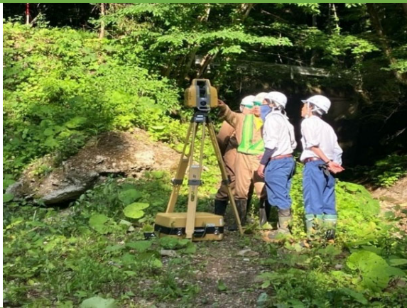
地上型レーザースキャナによる三次元計測
