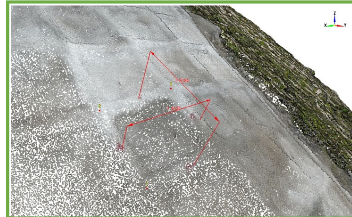
三次元計測データによる出来形管理 (枠中心間隔)
