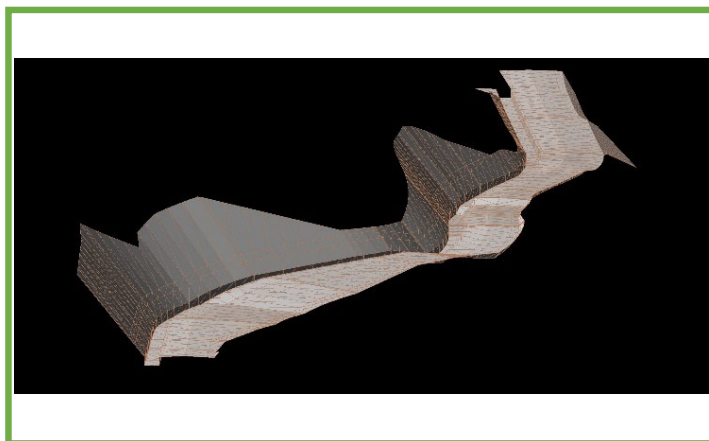
3次元起工測量による3次元モデル
