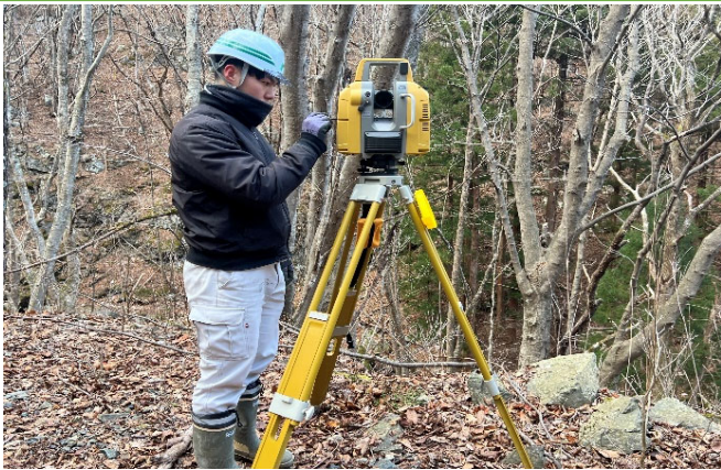
地上型レーザスキャナでの点群測量
