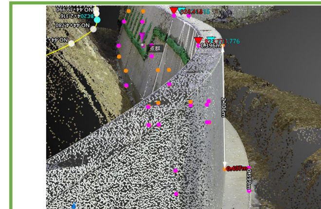
点群出来形計測状況
