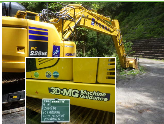
ICT機械(3次元マシンガイド)バックホウ山積0.8m 3 )
