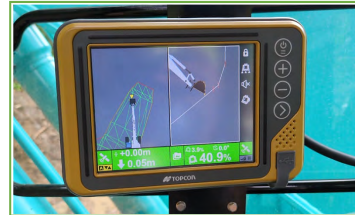
ICT建機による掘削時のモニター
