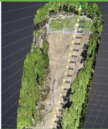
3次元起工測量データ
