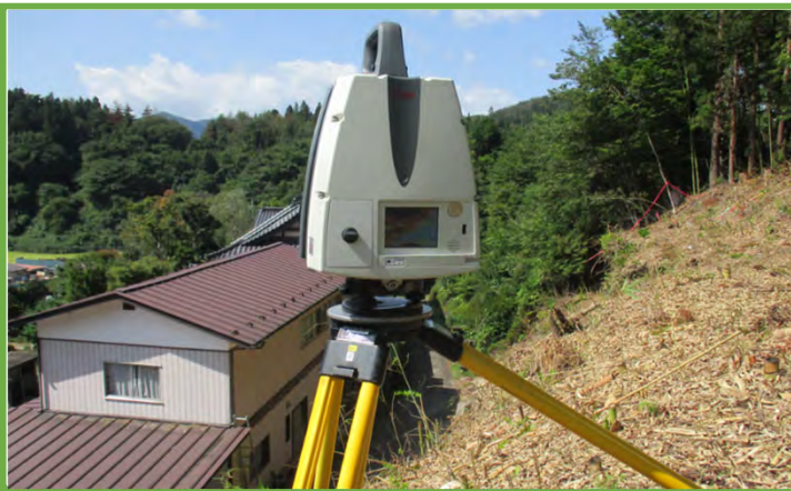
3次元地上型レーザースキャナーを用いた測量
