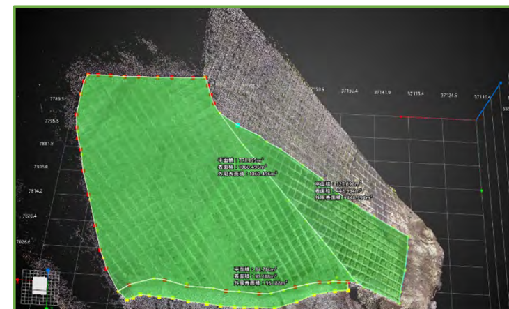
3次元データによる出来形管理
