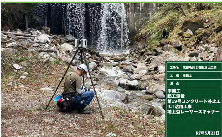
地上型レーザーを用いた起工測量
