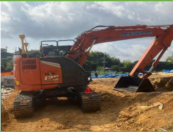
使用機械(MCバックホウ(0.45m3))
