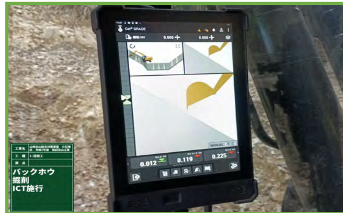
ICT建機掘削（運転席モニター）
