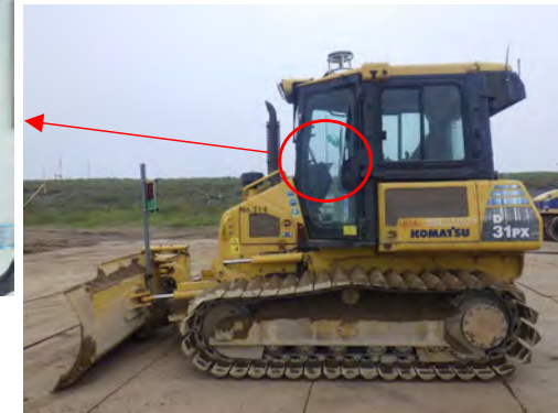
ICT建機：転圧管理システム(Geo-Press Cloud)
