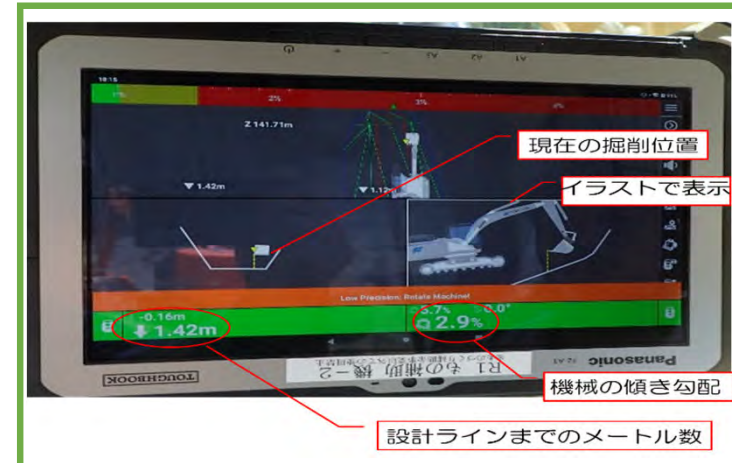
建機内モニターには設計ラインまでのメートル数及び重機の傾き勾配が数値化
