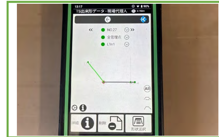
TS等光波方式を用いた出来形計測
