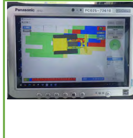
ICT建機：転圧管理システム(Geo-Press Cloud)
