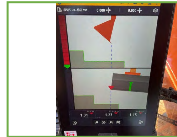
段切り施工時のバックホウ内モニター
