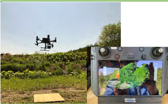
UAVによる起工測量
