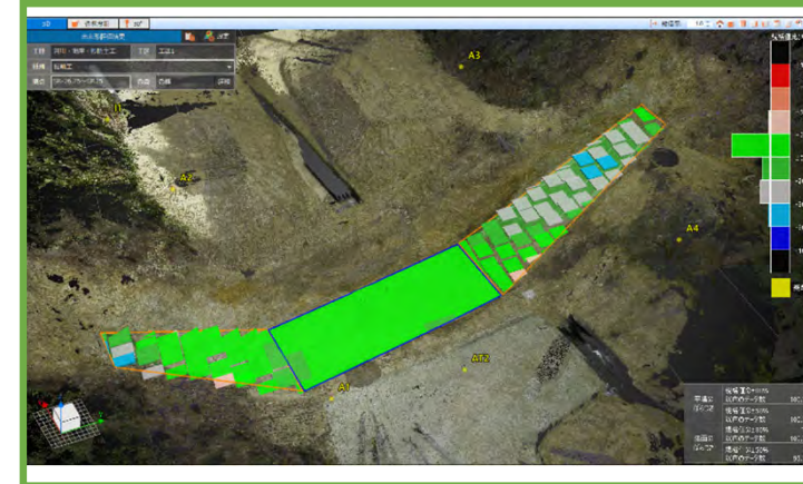
3次元データを用いた出来形管理
