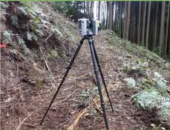
地上型レーザースキャナーによる起工測量
