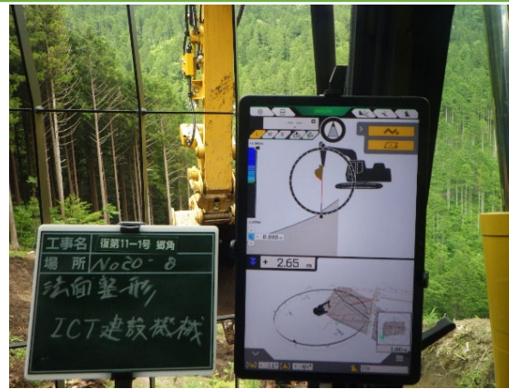
MGバックホウ運転席のモニター
