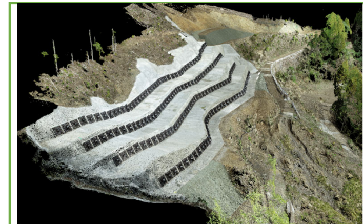
3次元点群データ (Web、PC上で計測等可能)
