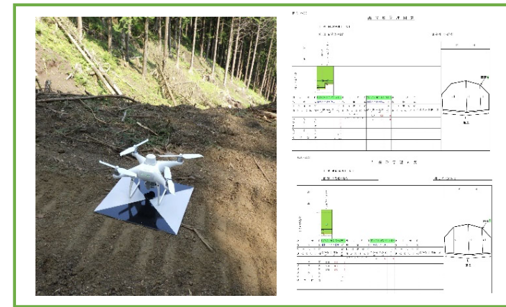
UAVにおける空中写真測量 法面工における出来形管理図
