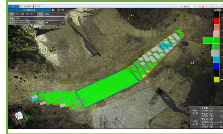
3次元データを用いた出来形管理
