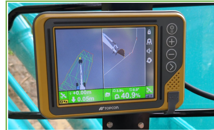
ICT建機による掘削時のモニター
