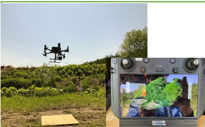
UAVによる起工測量
