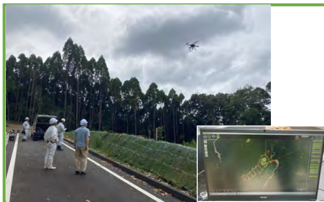
UAVレーザ測量状況
