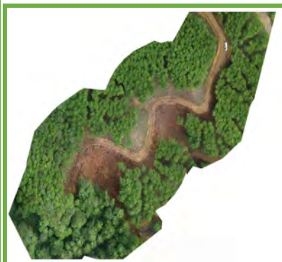
UAV測量により取得・作成したオルソ画像 (起工測量・出来形測量)
