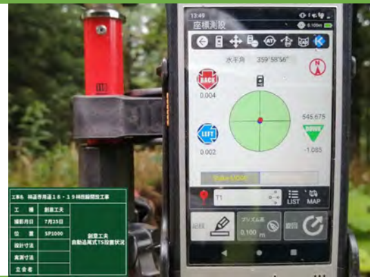
快測ナビによる施工管理
