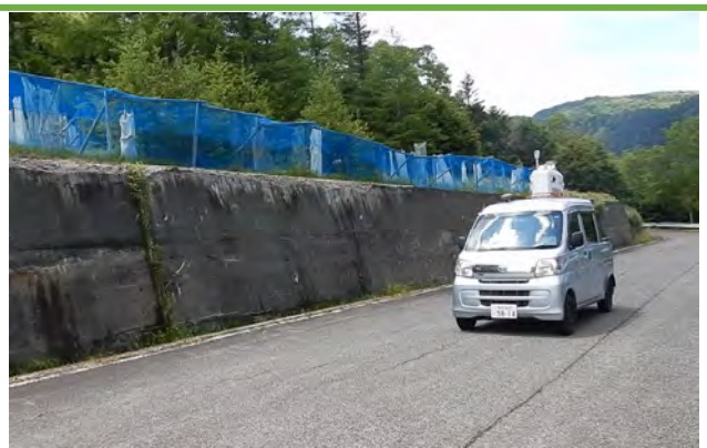
MMSによるレーザ測量実施
