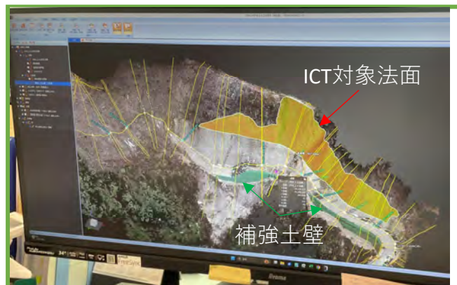
UAV空中写真測量による3次元データ ICT対象（掘削・法面整形）が一目瞭然
