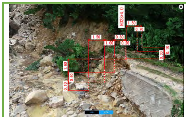
撮影した写真を3D化し、地形の変化点を計測し横断写真に表示
