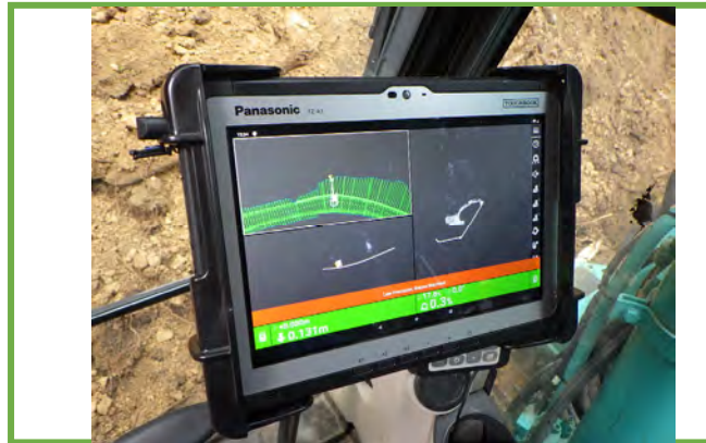
バックホウに備え付けられたタブレットで、計画断面とショベル先端の位置関係を把握
