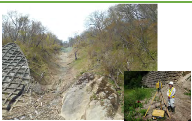
測量箇所及び 測量に使用した地上レーザスキャナ
