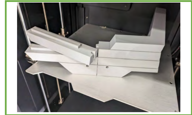
鉛直・垂直打ち継ぎ目を活用した 治山堰堤3Dプリンター出力
