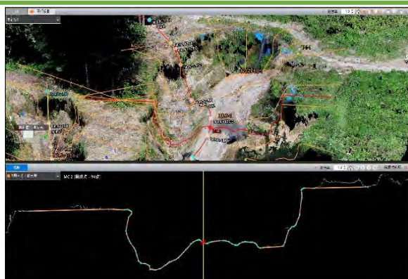
3次元起工測量データ
