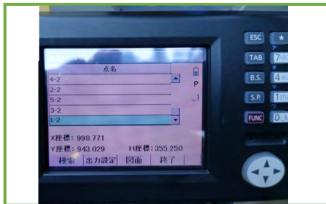
掘削面座標表示画面
