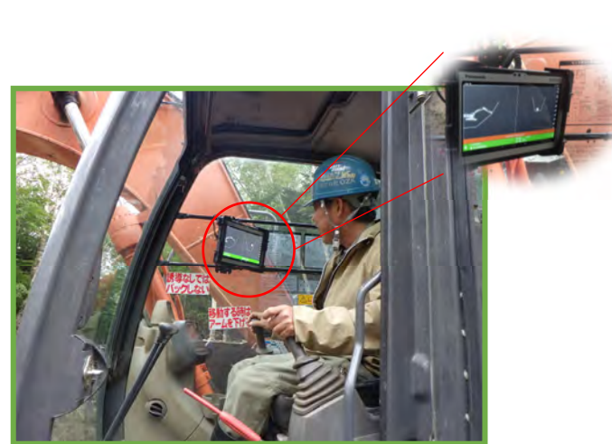
3次元設計データとバケット位置のモニター確認
