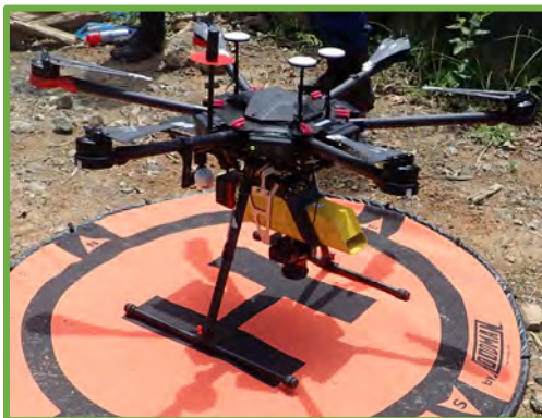
測量に使用した UAVレーザ測量機器
