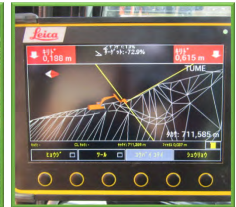
ICT建機内のモニター画像
