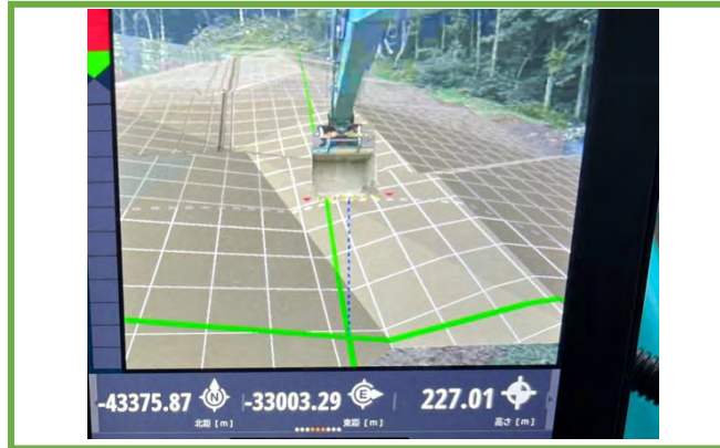
バックホウに取り付けたカメラの映像と 設計データを組み合わせたAR
