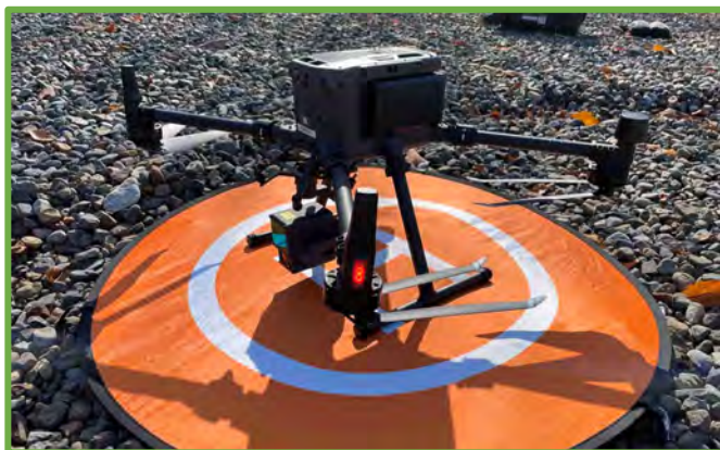
飛行機体：DJI Matrice 300 RTK レーザスキャナ：DJI Zenmuse L1
