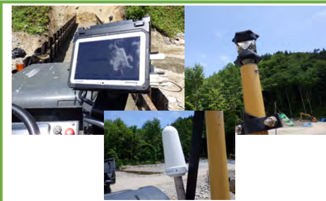
TS機器 (車載モニター、追尾用全周プリズム、受信アンテナ)
