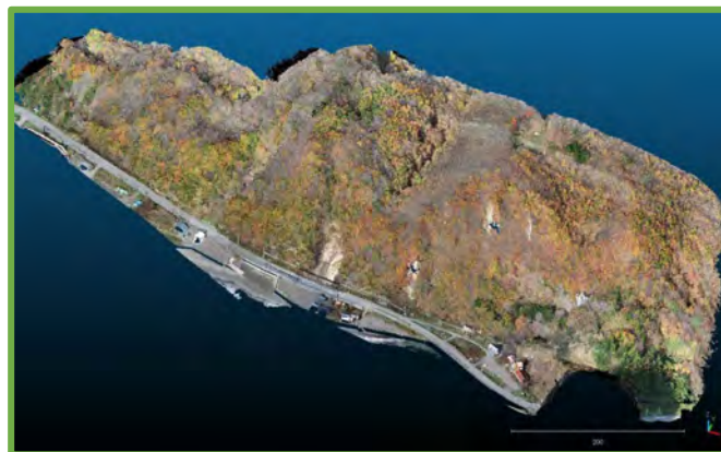
取得したオリジナル点群による広域現況把握 (計測時期：11月)
