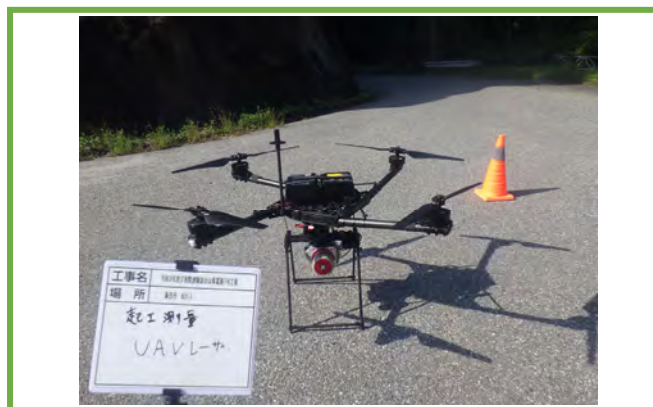
UAVレーザによる起工測量
