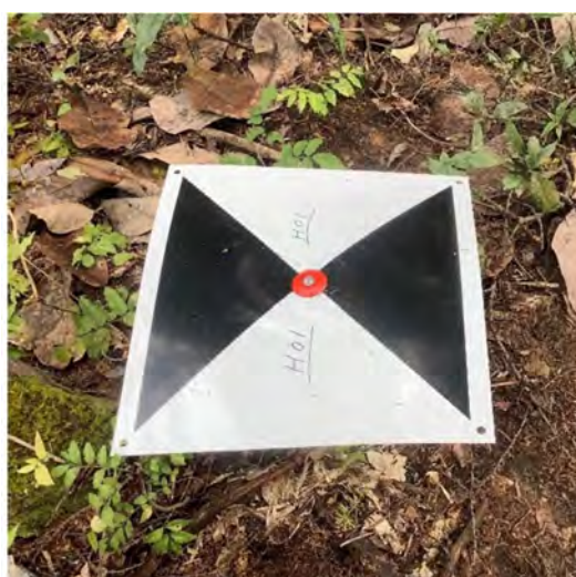
写真 6-1 対空標識の設置状況
