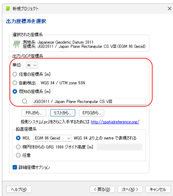
図 8-3 出力座標系の設定例 (赤枠部：JGD2011 の第 8 系を選択)
