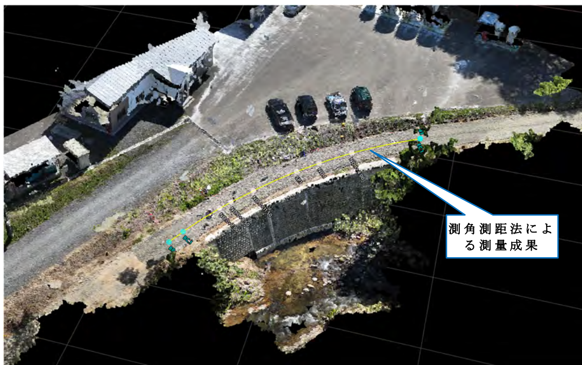
図 5-3 UAV写真測量と測角測距法の成果の結合例 (事例：国有林内の林道災害箇所)
