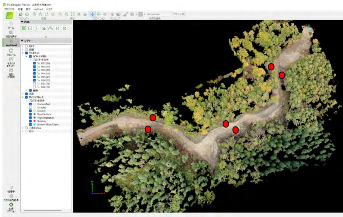
図 4-4 標定点の設置計画例（6点）
