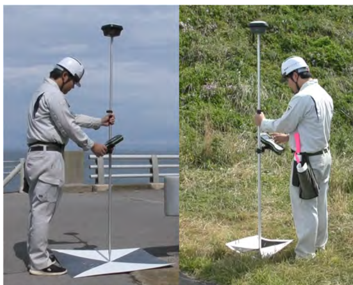
写真 6-2 RTK・GNSS測量機器での測量状況
