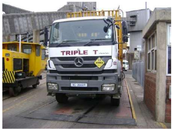
トラック積荷重量の点検
