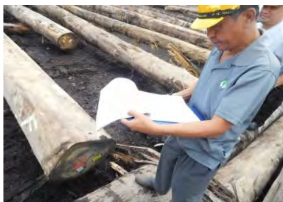
ハーウッドティンバー社の社員が丸太を検量し、検量した丸太と丸太荷口明細書その他の添付書類のデータとの整合性を確認する。
