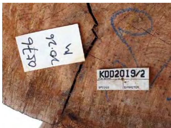
丸太の材長が長い場合、輸送のために丸太を複数の玉に切り分けた場合は、樹木タグ番号に枝番を付ける。この場合は、KDD2019番の丸太を玉切した二番目の玉であることでの表示である。
