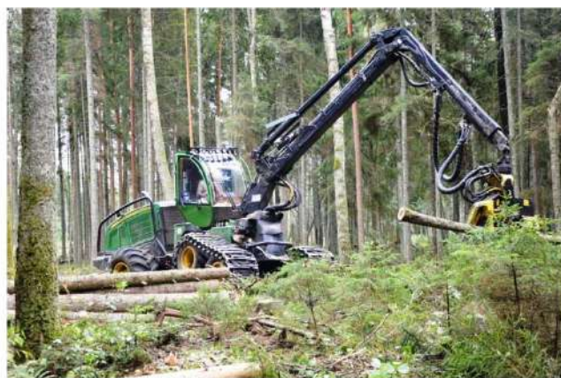
ハーベスタで枝払い、玉切作業をするときに、丸太の寸法及び材積を自動測定し、木材輸送証明書のデータとする。 協力：国有林経営センター
