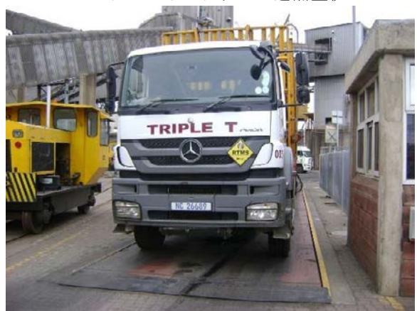
トラック積荷重量の点検
