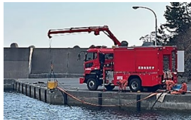
海水利用型消防水利システム (スーパーポンプ)
