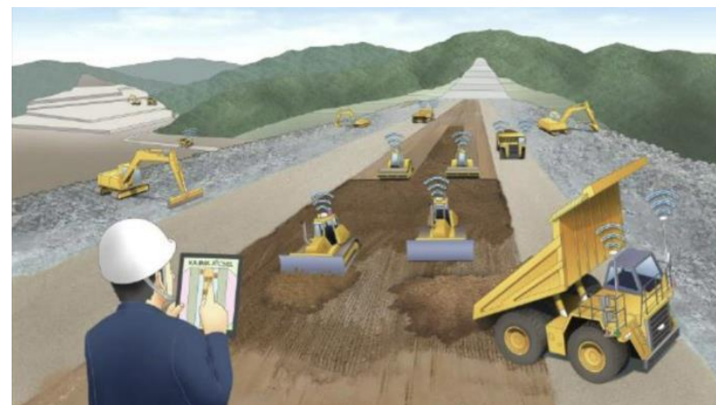
出所：鹿島建設(株) 建設機械の自動化システム「A4CSEL®」に自動ダンプトラックを導入 https://www.kajima.co.jp/news/press/201701/11c1-j.htm
