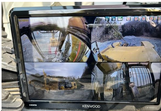
安全性の改良のため、 アシストされた機械から遠隔カメラで アシスト状態を確認する。
