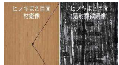
真上から照明されたヒノキ材（左）を顕微鏡で拡大（右）。白い部分が光をよく反射している。
