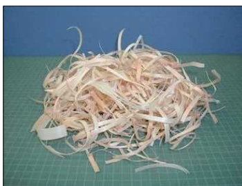
ヒノキ材 スライス片 (幅 5mm、厚さ 0.1~0.3mm、長さ 50~400mm)
