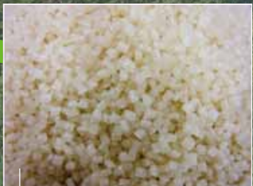
セルロース ナノファイバー 含有ポリプロピレン コンパウンド (協力：(株)トクラス)
