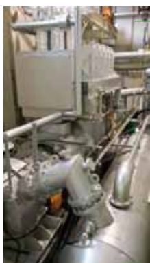
(写真3) 施設園芸用温風器での燃焼試験(協力 株相愛)
