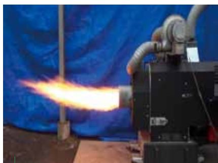
(写真3) 施設園芸用温風器での燃焼試験(協力 株相愛)
