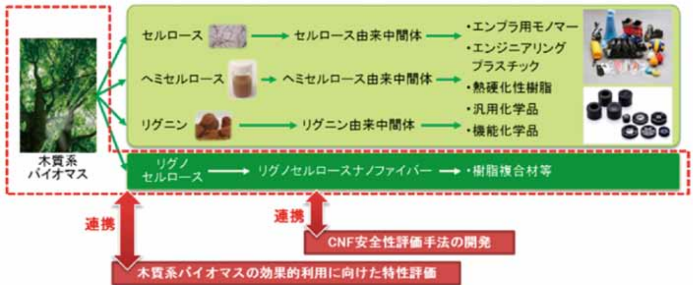
図1 非可食性植物由来化学品製造プロセス技術開発のプロジェクト全体像 (NEDO HPより)
