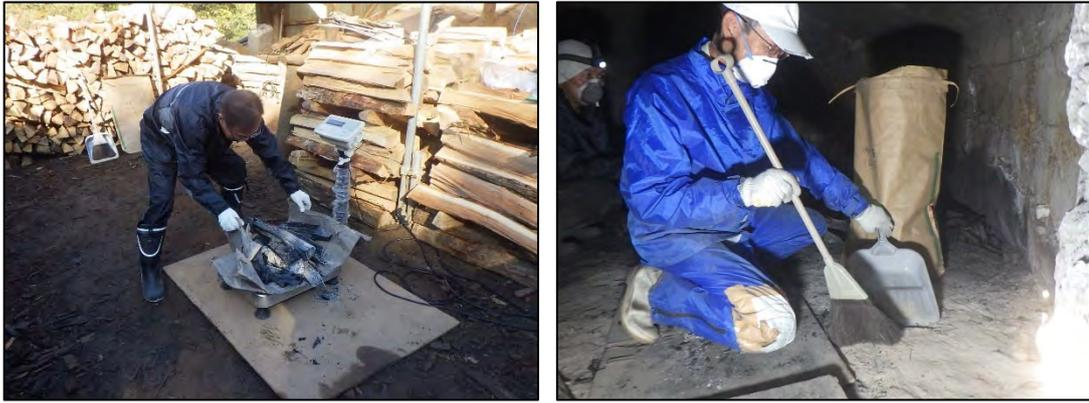
図 2-12 製炭木炭の重量測定、灰の採取状況
