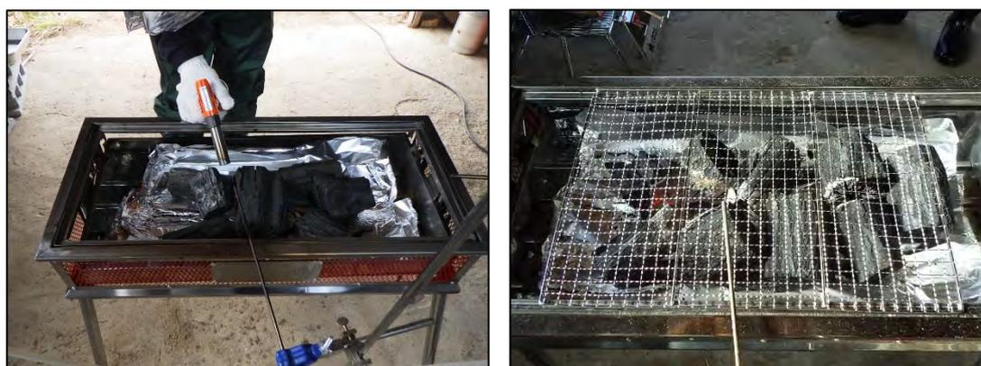
図 2-38 使用した焼き台（木炭の燃焼試験で使用した BBQ コンロと同じ。）
