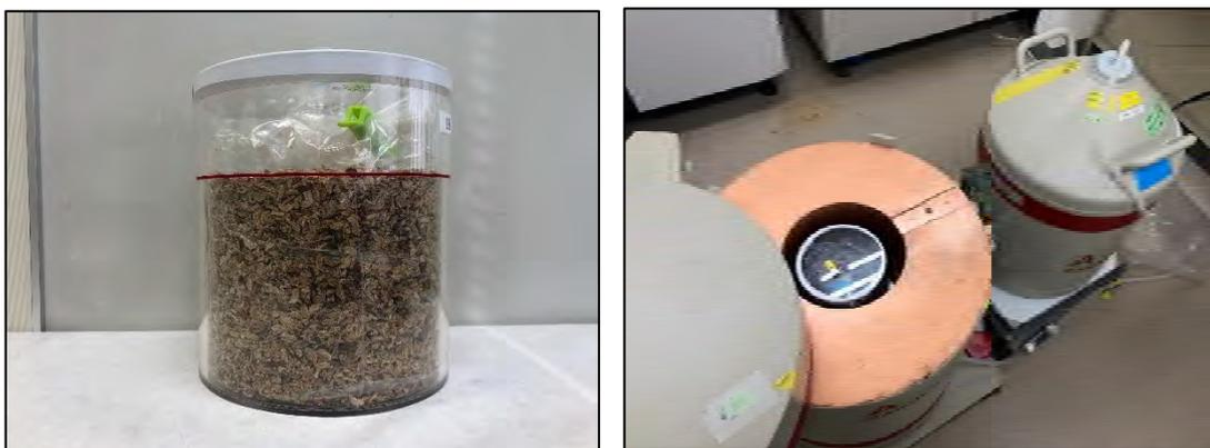
図 2-7 Ge 半導体検出器による原木中放射性 Cs 濃度の測定
