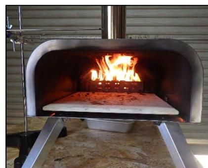
令和 4 年度の調査で使用されたピザ窯 (後方で薪を燃焼させる構造で、気流と共に灰が前方に舞う。)
