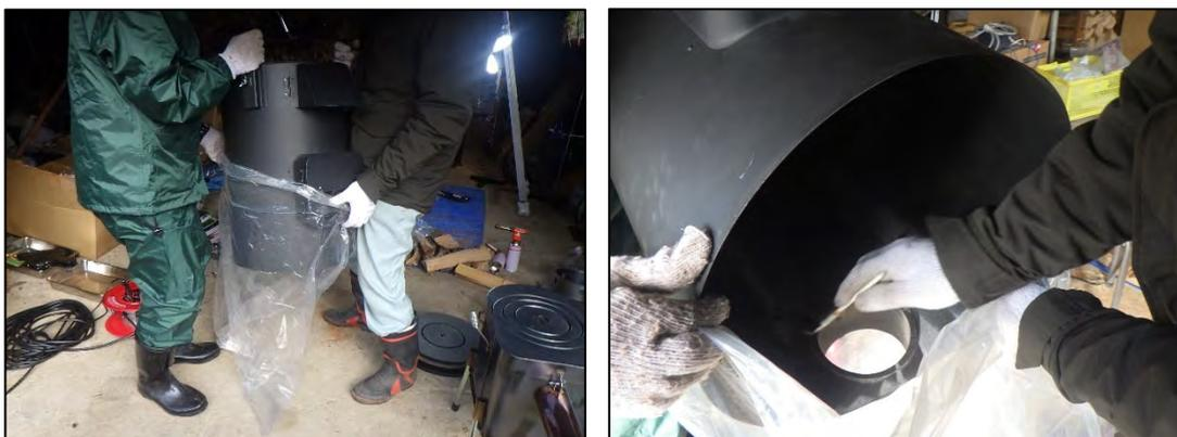
図 2-20 燃焼灰の採取状況（カマド）
