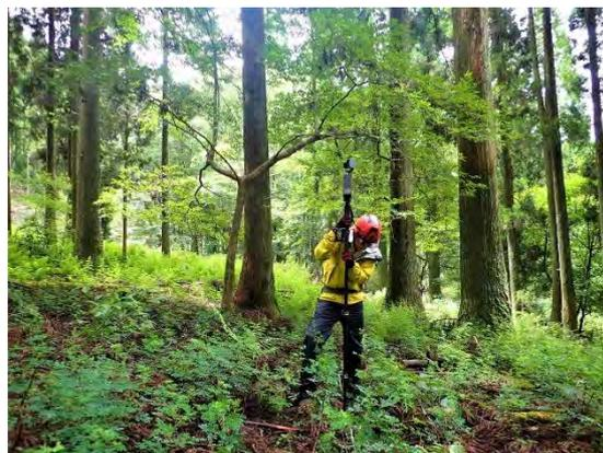
地上レーザ計測による収穫調査
