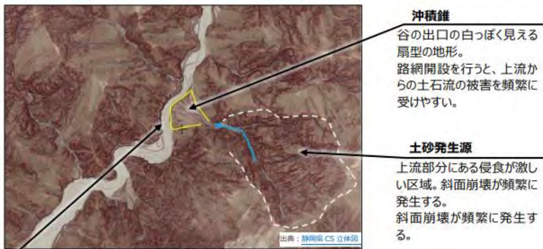
図 4.1.10 CS 立体図を使った地形判読の事例 出典：林野庁「CS 立体図を使った地形判読マニュアル」
