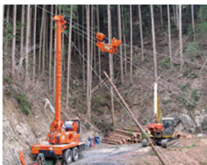
図43 架線集材の例 左:タワーヤード、右:スイングヤード
