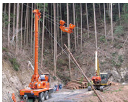
図43 架線集材の例 左:タワーヤード、右:スイングヤード
