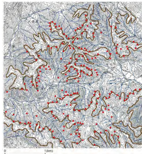
図21 2010年7月の広島県庄原災害の表層崩壊発生位置図（赤点：崩壊発生位置、太線：遷急線）
