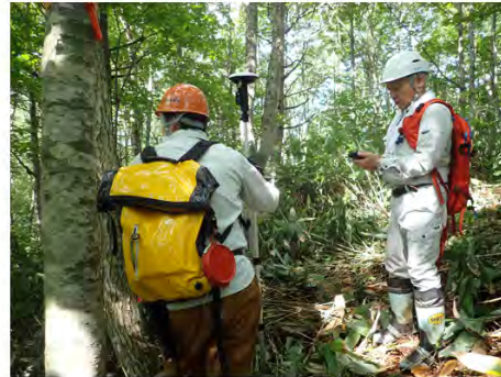
現地で修正した作業道幹線の線形を高精度GNSSで測量
