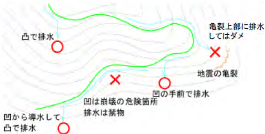
図 5.1.6 崩落危険箇所を考慮した排水の例
