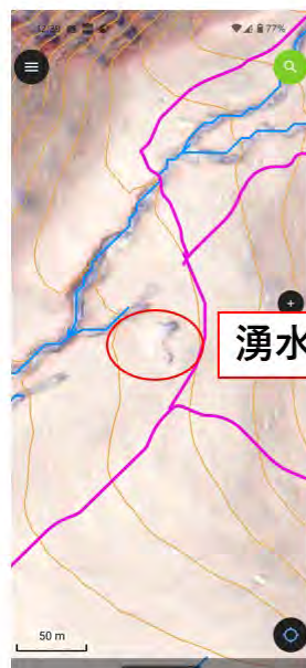
図 5.3.3 携帯端末に CS 立体図を表示して現地調査したところ湧水箇所を発見
