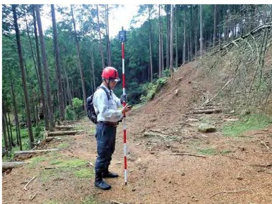
高精度 GNSS による計測
