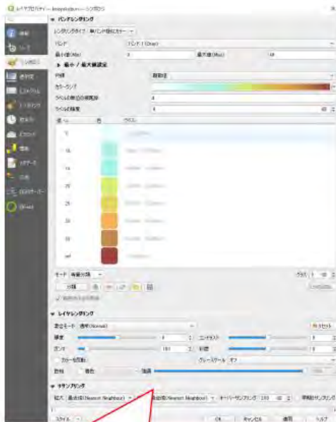
⑩傾斜区分図の階層設定の例 0度から5度刻みで35度以上へ
