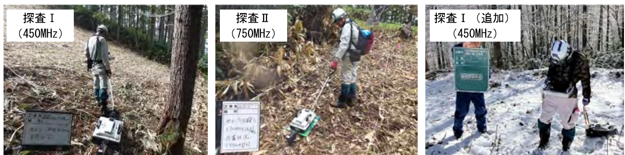
写真 3-3 地中レーダー探査状況
