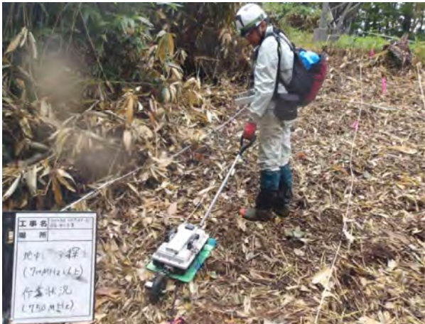
MALA GX 750 HDR 測定状況
