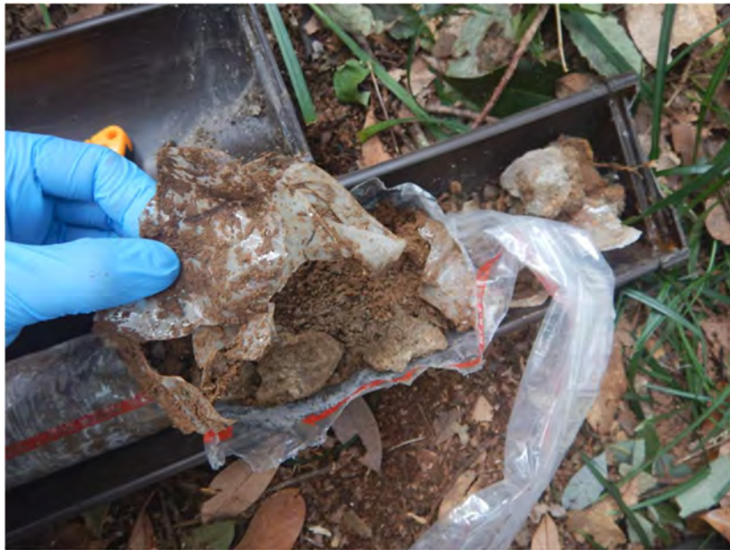
図 5-4 固化物直上で確認されたビニル片
