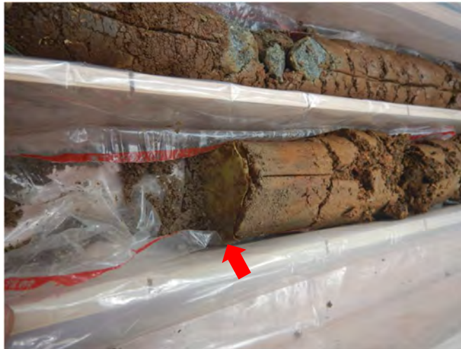
図 5-9 固化物直下で確認されたビニル片 (No. 2-1)
