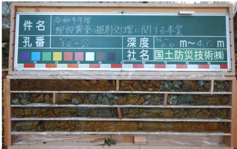
図 4-11 周辺土壌の土質状況 (E)
